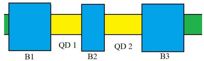
Рис. 1. Структура с двумя квантовыми точками (QD1, QD2), образованными тремя магнитными барьерами (B1, B2, B3) на краю топологического изолятора на базе квантовой ямы HgTe/CdHgTe
