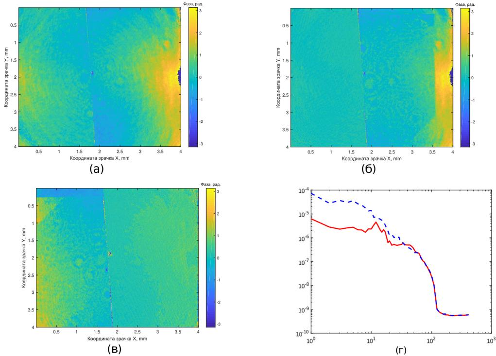
**Рис. 13.** Коррекция плоского ВФ: а) нескорректированный ВФ; б), в) скорректированные левая и правая полуплоскости; г) усредненный по радиальным сечениям спектр мощности ошибок (PSD), синяя штриховая линия — до коррекции, красная сплошная линия — после коррекции
