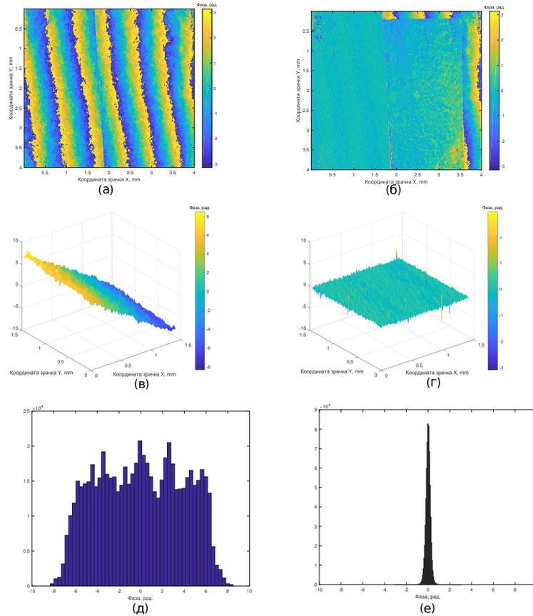
**Рис. 11.** Коррекция ВФ, содержащего наклон плоскости зрачка более чем на  $2.5\lambda$ : а) нескорректированный ВФ, б) скорректированный ВФ, в), г) нескорректированный и скорректированный фрагменты ВФ с соответствующими гистограммами отсчетов д, е
