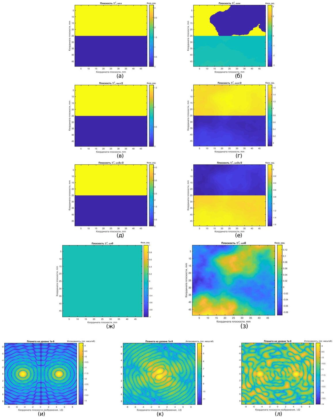
Рис. 7. Коронаграфические изображения для начального контраста  $C = 10^9$ , когда поданы aberrации  $\Sigma_0$  или  $(\Sigma_0 + \Sigma_{NCPA})$ , определен и подан корректирующий фазовый компонент  $-\phi(u', v')$
