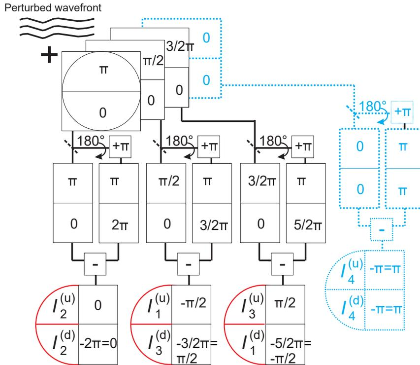
Рис. 4. Схема фазовой модуляции в зрачковой плоскости и соответствующие трехшаговому алгоритму (8), (9) значения интенсивностей  $I_{1...3}^{(u)}$ ,  $I_{1...3}^{(d)}$  для верхней ( $u$ ) и нижней ( $d$ ) половин поля вторичного зрачка. Синим цветом дополнены модуляция и интенсивности  $I_4^{(u)}$ ,  $I_4^{(d)}$  для четырехшагового алгоритма (10), (11)
