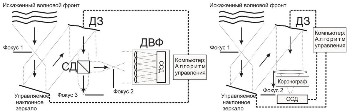
Рис. 2. Схемы коррекции волнового фронта посредством адаптивной оптики (АО). Левая панель (а) — пример построения стандартной схемы АО (с ДВФ). Правая панель (б) — схема АО для коронографического высококонтрастного метода (без ДВФ)
