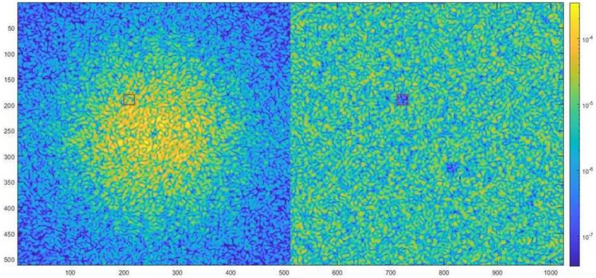
**Рис. 3.** Результаты моделирования (тривиальной зональной) коррекции волнового фронта, содержащего спекл-поле. Слева — нескорректированное спекл-поле в плоскости изображения после интерференционного коронографа, где красным квадратом показана область коррекции. Справа — ослабленное спекл-поле в зоне коррекции и симметричной области для интерференционного коронографа по схеме интерферометра вращательного сдвига (ИВС 180°), см. [2]
