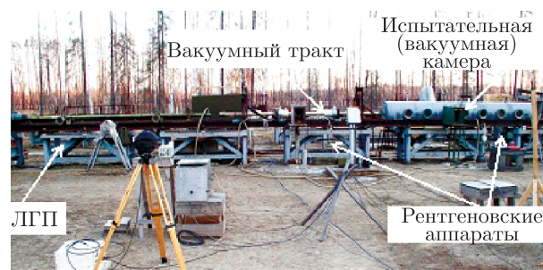
Рис. 2. Панорама проведения эксперимента с легкогазовой пушкой (ЛГП)
