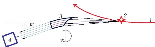
Рис. 1. Схема получения пучка вторичных частиц: 1 — циркулирующий протонный пучок; 2 — внутренняя мишень; 3 — кристаллический фокусирующий элемент; 4 — зона физической установки
