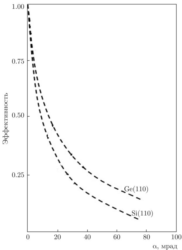
Рис. 4. Эффективность поворота пучка протонов, захваченного в режим канализации, от угла изгиба  $\alpha$  кремниевого и германиевого кристаллов
