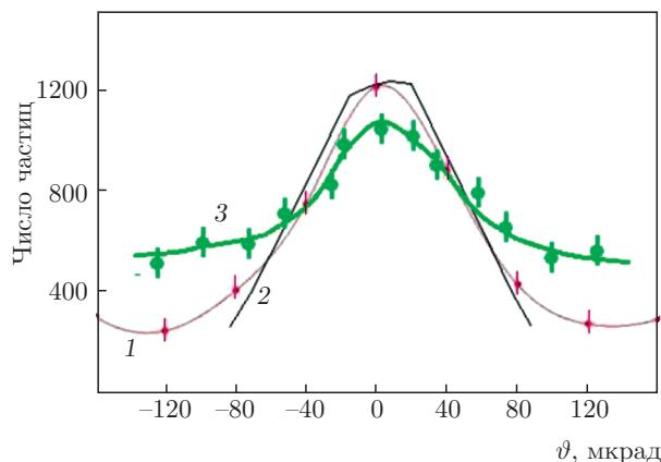
**Рис. 8.** Ориентационные зависимости количества отклоненных кристаллом частиц кривая 1 с точками — эксперимент для протонов; кривая 2 — расчет для протонов; кривая 3 с точками — эксперимент для вторичных частиц
