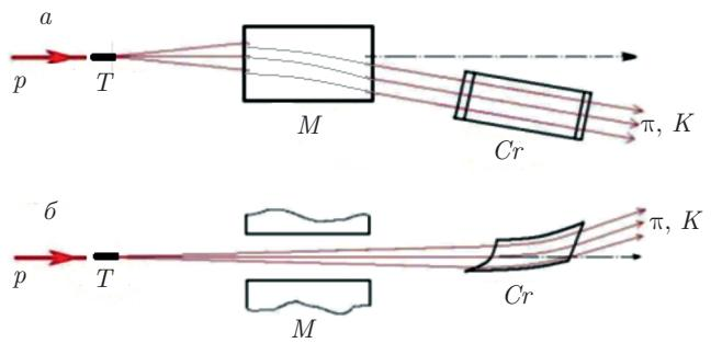
Рис. 5. Схемы формирования вторичного пучка с узким интервалом импульсов в горизонтальной (а) и вертикальной (б) плоскостях:  $T$  — мишень;  $Cr$  — кристалл;  $M$  — магнит
