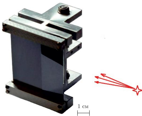
Рис. 2. Внешний вид кристаллического фокусирующего устройства
