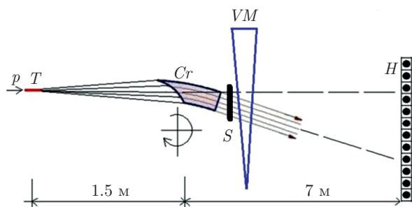
**Рис. 6.** Схема опыта:  $T$  — мишень из  $\text{CsI}$ ;  $Cr$  — кристалл в гониометре;  $S$  — миниатюрный сцинтиллятор;  $VM$  — вертикальный магнит;  $H$  — сцинтилляционный гадоскоп
