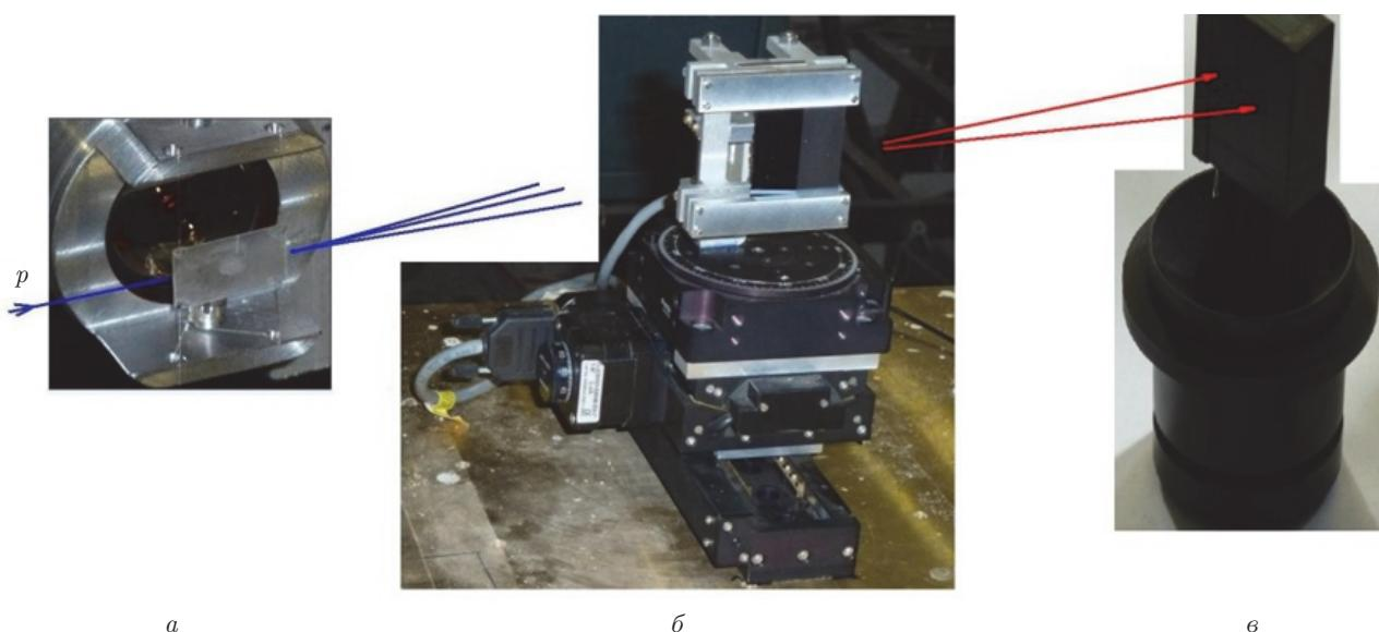
**Рис. 7.** Внешний вид основных элементов установки: *а* — активная мишень для рождения  $\pi$ -мезонов; *б* — фокусирующий кристалл в гониометре; *в* — сцинтилляционный годоскоп на многоканальном ФЭУ для регистрации эффекта
