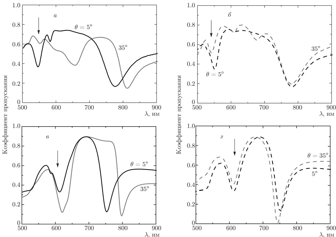
**Рис. 3.** Экспериментальные (а,б) и расчетные (в,г) спектры пропускания для структуры с периодом  $D_2$  для s-поляризации (сплошные линии) и p-поляризации (штриховые линии) света при разных углах падения  $\theta$  на образец
