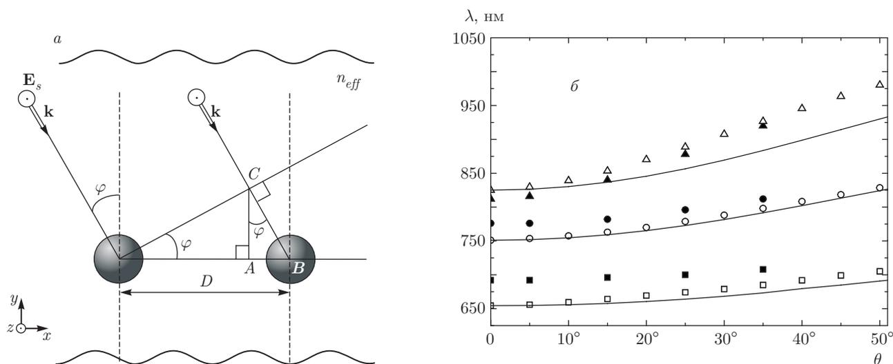
Рис. 5. *a*) Иллюстрация к объяснению спектрального смещения РППР в случае наклонного падения *s*-поляризованного света. *б*) Зависимости спектрального положения РППР от угла падения  $\theta$  для структур с  $D_1$  (квадраты),  $D_2$  (кружки) и  $D_3$  (треугольники): расчет — светлые символы; эксперимент — темные символы; сплошные линии — спектральное положение РППР согласно зависимости (5)
