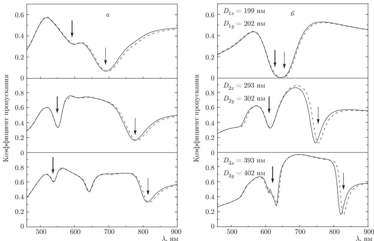
Рис. 2. Экспериментальный (а) и теоретический (б) спектры пропускания для структур с периодами  $D_1$ ,  $D_2$  и  $D_3$  при нормальном падении света на образцы при напряженности электрического поля вдоль оси  $x$  (сплошные линии) и вдоль оси  $y$  (штриховые)
