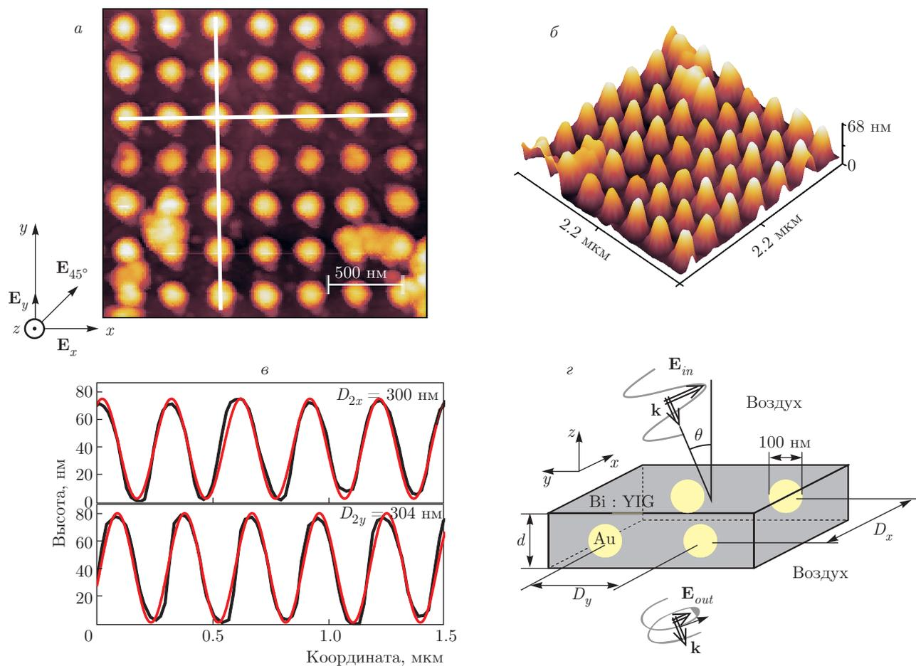
Рис. 1. а, б) Изображения, полученные с помощью АСМ при исследовании образца с периодом  $D_2 \approx 300$  нм. в) Сечения поверхности изображения на рис. 1а и их аппроксимация синусоидальной функцией. г) Модель для численного моделирования
