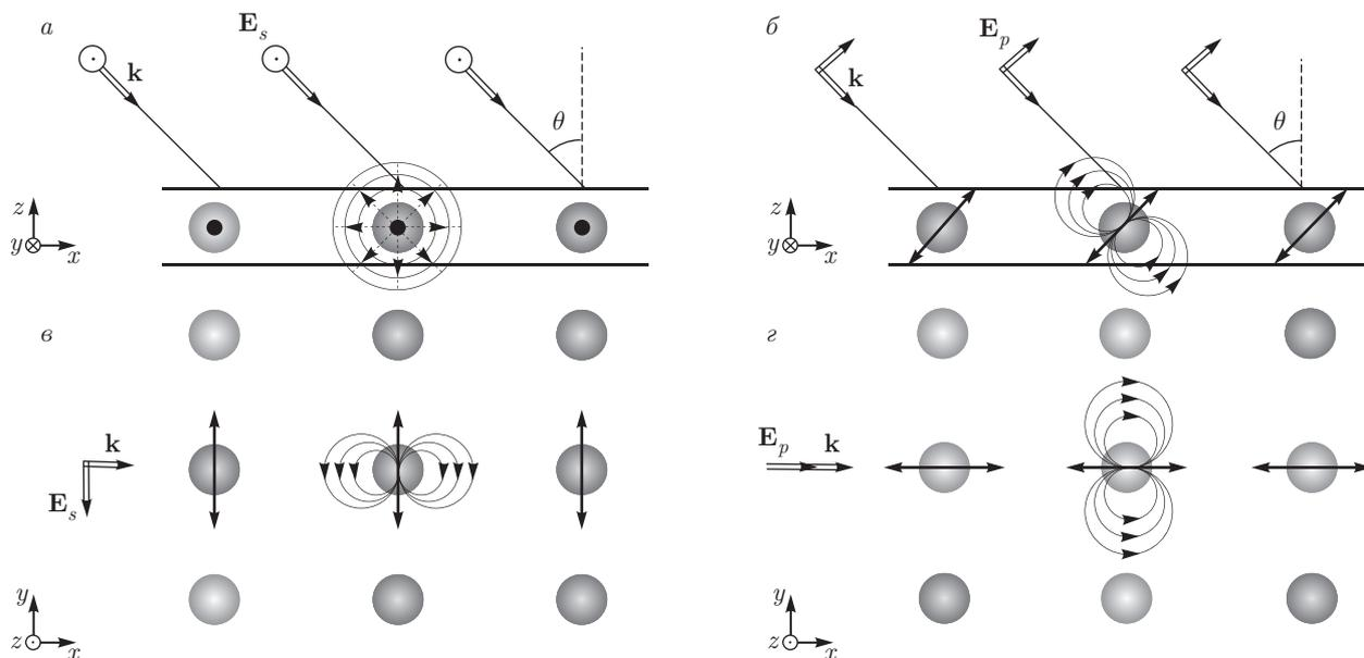
Рис. 4. Иллюстрация к объяснению спектрального смещения РППР в случае наклонного падения *s*-поляризованного (*a, б*) и *p*-поляризованного (*б, z*) света на исследуемую структуру: *a, б* — вид сбоку; *б, z* — вид сверху
