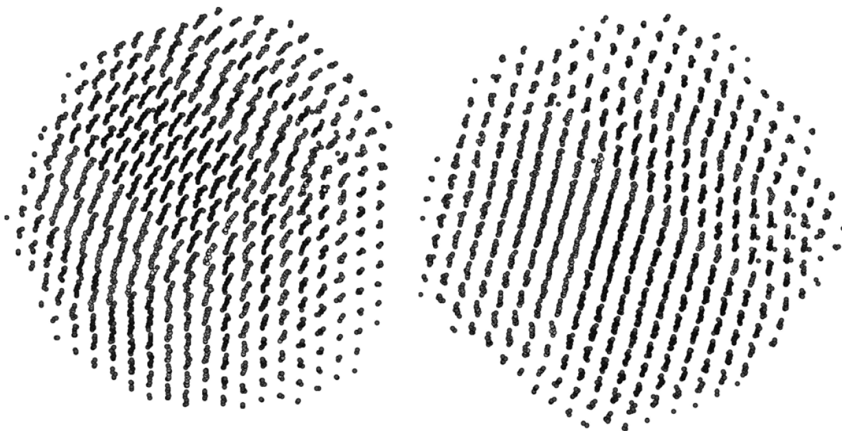
Рис. 8. Двойниковые структуры, получаемые при охлаждении нанокластеров золота ( N = 3805 ) в приближении канонического ансамбля
