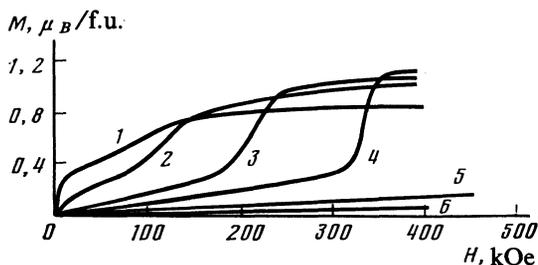
FIG. 2. Magnetization curves for  $\text{Y}(\text{Co}_{1-x}\text{Al}_x)_2$  at 4.2 K: 1)  $x = 0.15$ ; 2) 0.125; 3) 0.10; 4) 0.075; 5) 0.05; 6) 0.
