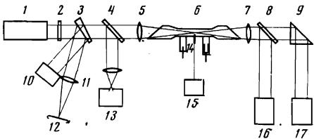
FIG. 1. Schematic diagram of the apparatus: 1) laser; 2) quarter-wave plate; 3), 4), 8) beam-splitting wedges; 5), 7), 11) lenses; 6) discharge tube filled with helium; 9) rotating prism; 10) coaxial photocell; 12) photographic plate; 13) calorimeter; 14) probe; 15) differential amplifier; 16) spectograph; 17) Fabry-Perot interferometer.
