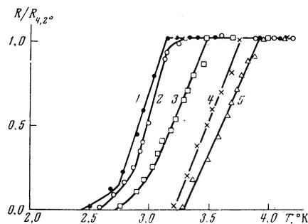
FIG. 5. Curves of the superconducting transition in lead at various pressures  $P$  (kbar): 1—200, 2—175, 3—168, 4—160, 5—135.
