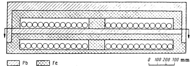
FIG. 2.  $\mu$ -meson detector.
